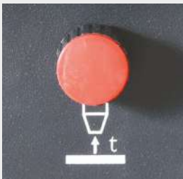
Функція «Прогар» видаляє кульки на кінці зварювального дроту і забезпечує чистий запуск зварювання
