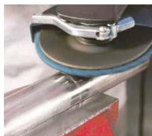
Шліфування зварних швів і видалення слідів на метали
