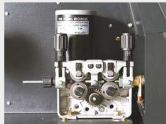
Чотири ролики подачі дроту забезпечують стабільну швидкість. Особливо важливо для алюмінієвого дроту
