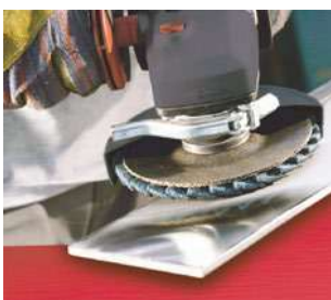
Полірування нержавіючої сталі
